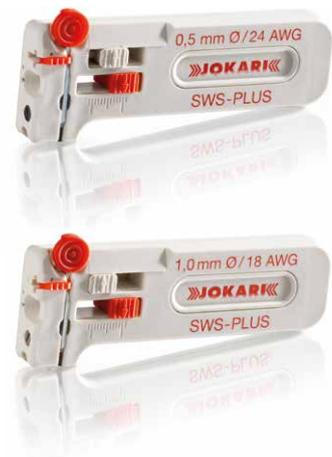
Ideal para eletrônicos e aplicações em TI. Diâmetro de decapagem ajustável a partir de 0.12 até 1.00 mm Ø (36 - 18 AWG). Com tampa de parada e função de corte integrada para cabos de até 0.8 mm Ø. Feitos a partir de material especial termoplástico dissipativo.
