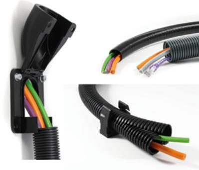
O passa-cabos para tubos anelados CONFiX-FWS é utilizado para a passagem de cabos através de tubos corrugados. A tampa oscilante está firmemente fixada por uma dobradiça na caixa de montagem. Trata-se de um sistema muito fácil de montar.
