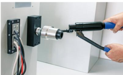
A icotek oferece um Furador manual hidráulico, compacto, que permite a furação rápida e fácil de furos retangulares, quadrados ou redondos, em aço inox, aço macio, alumínio e plástico. Os furos ajustam se exatamente às dimensões de corte da maioria dos sistemas de entrada de cabos da icotek. Quando é necessário fazer vários furos, o Furador hidráulico é muito mais rápido do que outras ferramentas do gênero.
