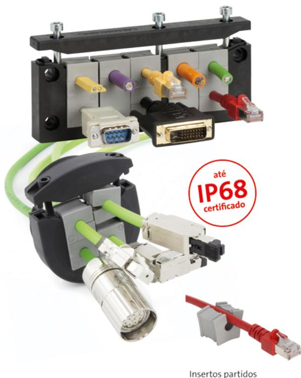
O sistema patenteado de entrada de cabos permite tanto a passagem de cabos pré montados, como de cabos sem conectores, garantindo estanqueidade e resistência à tração. O sistema de entrada de cabos KVT e QVT permite uma montagem rápida, fácil e sem ferramentas, excelente para retrofitting e manutenção.
