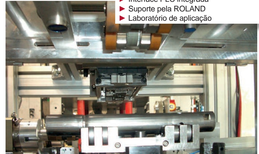
Teste de rachadura em componentes automotivos (Fonte: König Metall)
