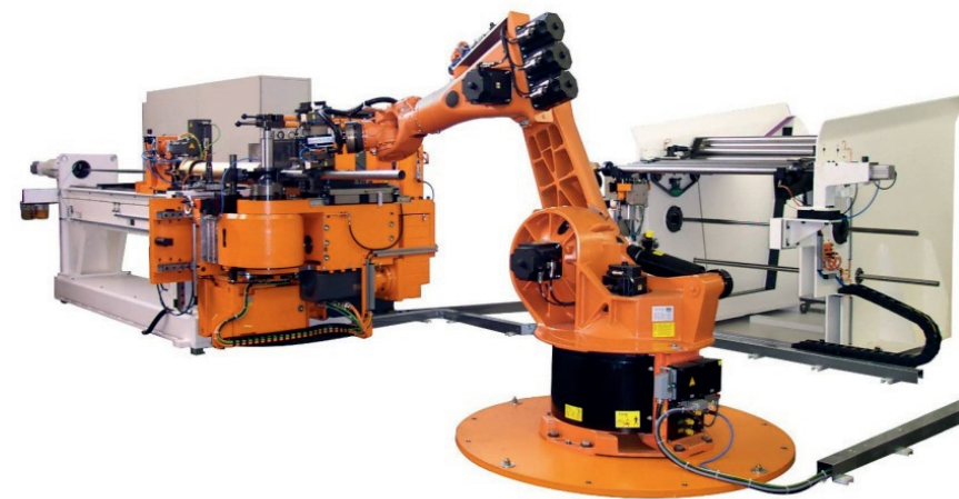
Máquina de dobramento de tubo com alimentadora automática (Fonte: Lang Tube Tec)
