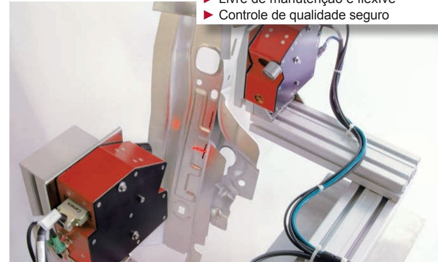
Inspeção de Geometria da Solda em componentes automotivos (Fonte: EHR®)
